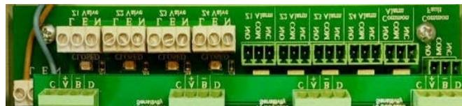
Connexions plug-in au bornier pour vanne d'arrêt et SGB
